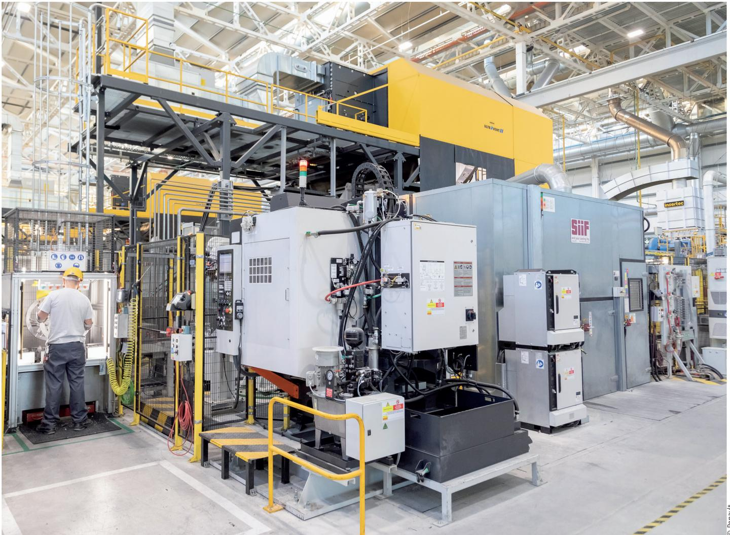
Bei Renault in Valladolid sind acht Druckgießmaschinen mit dezentralen KMA-Filterssystemen für den Abluftbetrieb ausgestattet
