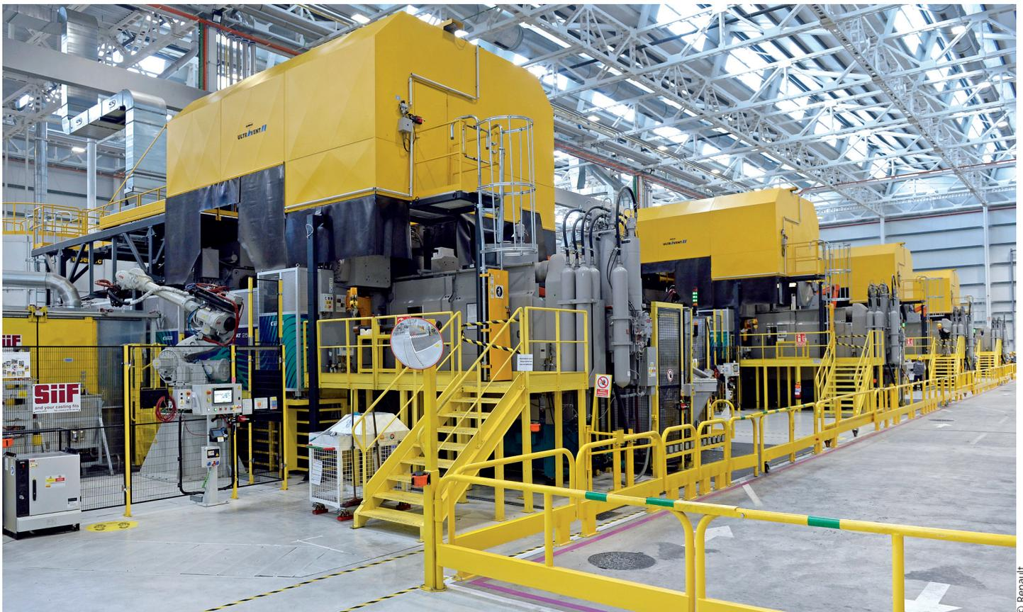
Druckgießmaschinen mit Ultravent-Abluftfiltern bei Renault in Valladolid
