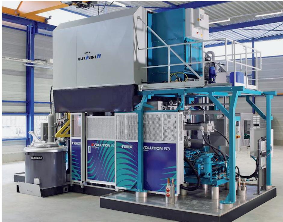
Druckgießmaschine mit KMA-Abzugshaube und Filter
